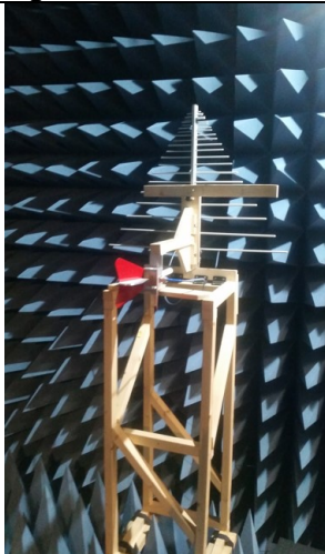
Fig.3 Antenne Yagi ed Horn per la trasmissione
